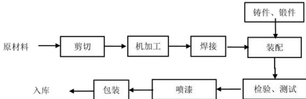
图 3-2 磁选设备生产工艺流程图
